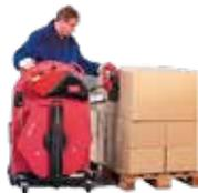
...y después se tensa y se sella de manera segura con la zunchadora.
