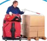
...llevando el zuncho directamente a la mano del trabajador. Entonces la lanza se retira. El elevador del zuncho lleva el segundo extremo del zuncho al trabajador a una altura adecuada para cogerlo sin agacharse ...
