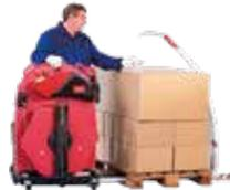
Coloque la ErgoPack delante del pallet. La lanza lleva el zuncho por debajo del pallet y lo sube por la parte trasera y por encima del pallet...
